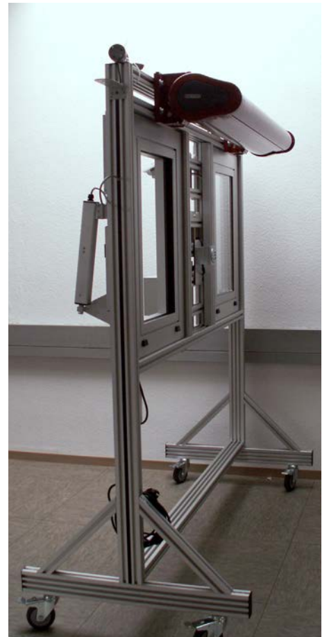
Schulungsstand Automatische Fenstersteuerung mit Witterungssensor und Notzentrale, ergänzt durch ein Dreh-, Kipfenster zur Montage- und Serviceübungen. Rückseitig ist eine elektrische Markise mit Wettersensor montiert.
