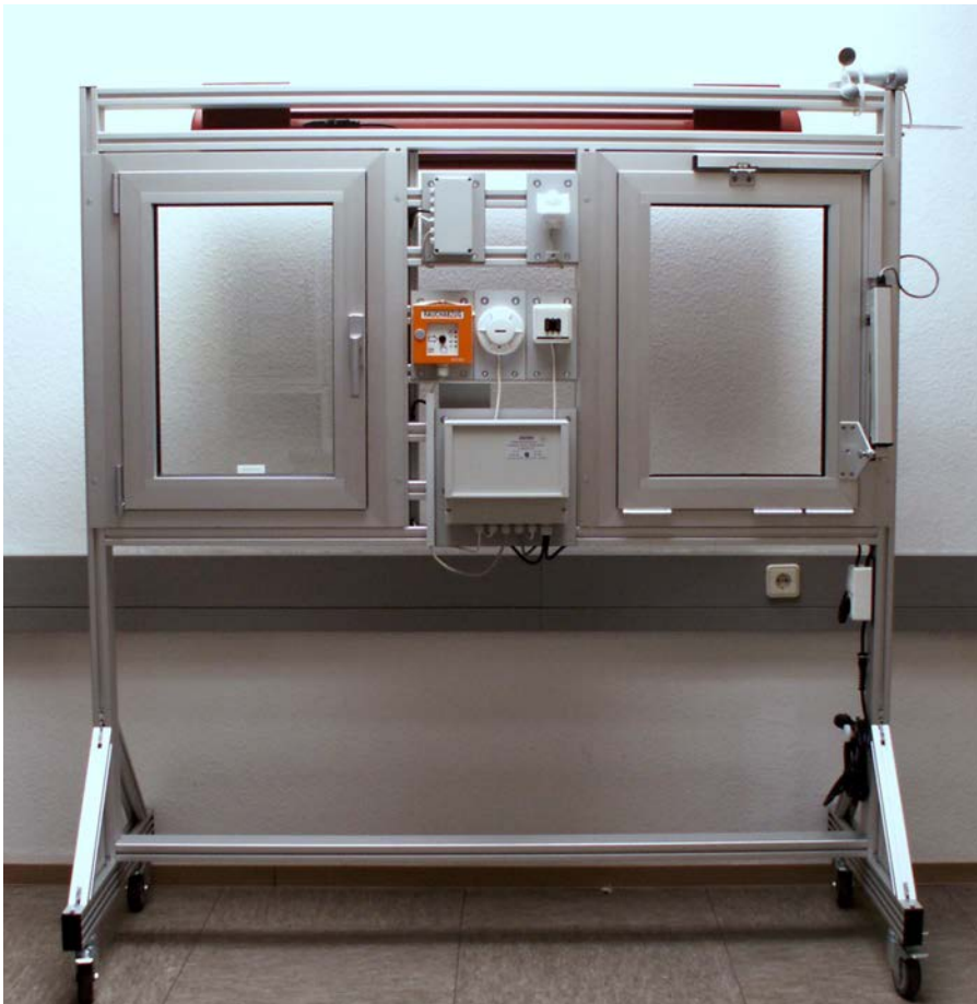
Schulungsstand Automatische Fenstersteuerung mit Witterungssensor und Notzentrale, ergänzt durch ein Dreh-, Kipfenster zur Montage- und Serviceübungen. Rückseitig ist eine elektrische Markise mit Wettersensor montiert.
